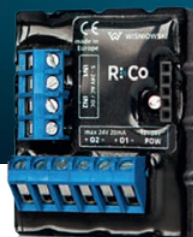
Ri-Co Pro (versione avanzata) comando che consente l'apertura e chiusura del portone e informa sullo stato del portone (aperto/ chiuso/stato intermedio).
