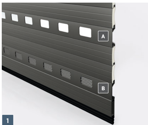
1 Il manto della serranda – è realizzato con profili in alluminio dall'altezza di 100 mm e dallo spessore di 25 mm riempiti con schiuma di poliuretano senza freon. (A) – profilo in alluminio singolo finestrato, (B) – profilo in alluminio singolo ventilato.
